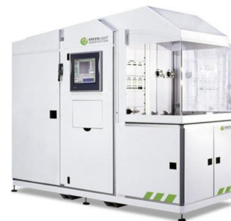
电堆测试平台 Stack Test bench
